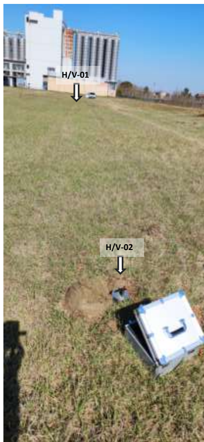
Figura 4: particolari delle prove dei rapporti spettrali "H/V-01-02" effettuate nell'area.
